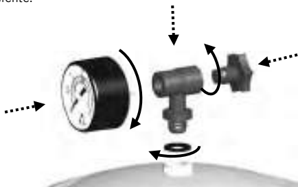
Montagem manômetro (válvula lateral)
