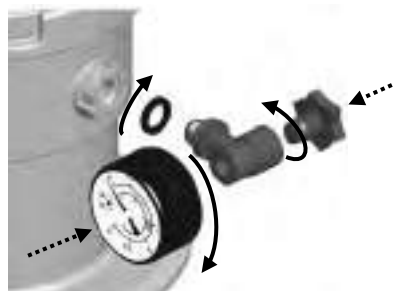
Montage des Manometers (Bei Top-Ventil)
