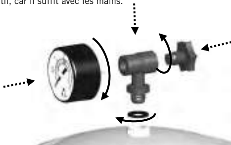
Montage du manomètre (avec vanne latérale)
