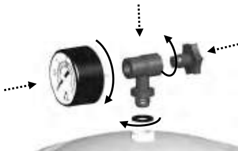
Montaggio manometro (con valvola laterale)
