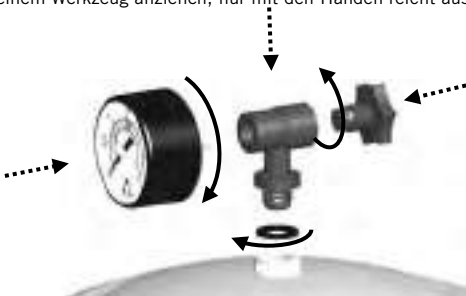
Montage des Manometers (Bei Seiten-Ventil)
