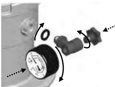
Montaggio manometro (con valvola top)
