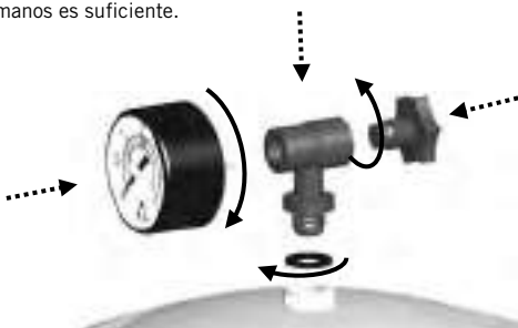
Montaje manómetro (con válvula lateral)
